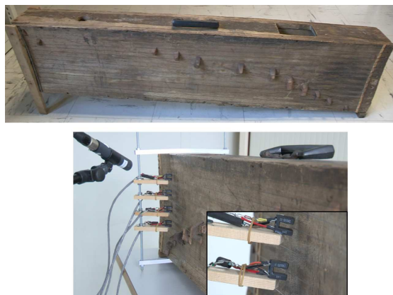
Figure 1. Photo de la cithare malgache (en haut) et du dispositif de captation optique (en bas)
